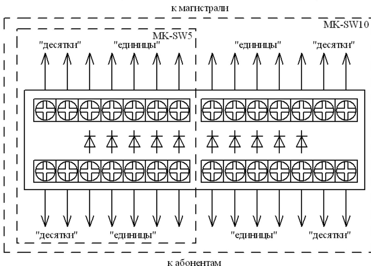
Рисунок 1. Схема подключения разветвителя трубок МЕТАКОМ МК-SW10 (МК-SW5).
